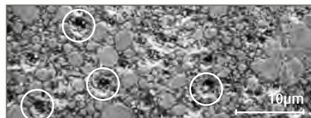
Filtek Supreme XT (3M Espe) 50 000 kuormitusyökin jälkeen. Täyteainehiukkasten irtoaminen näkyy selvästi.
