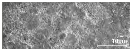
ESTELITE SIGMA QUICK (TOKUYAMA DENTAL) 50 000 kuormitusyökin jälkeen. Pinta on edelleen sileä.
